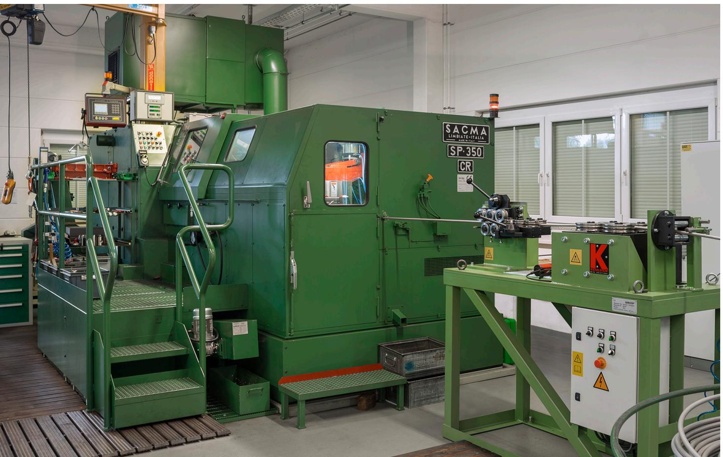
Modernste Kaltstauchpressen für Schweißbolzen bis Ø 16 mm
